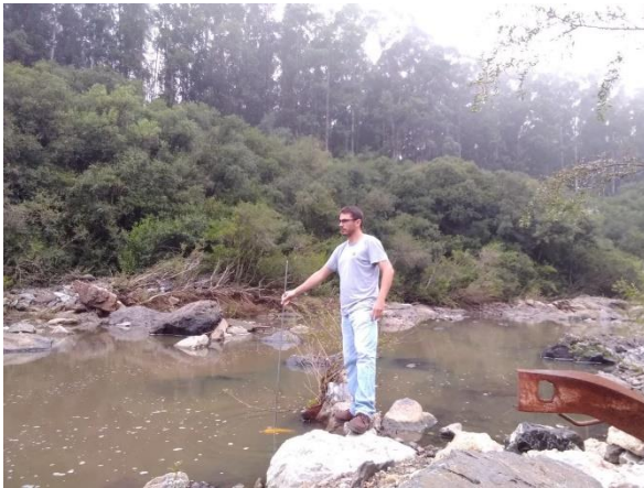
Figura 8 - Coleta de amostra para análise de sólidos em suspensão com o amostrador DH-48. Fonte: Ecosystem, 2021.
